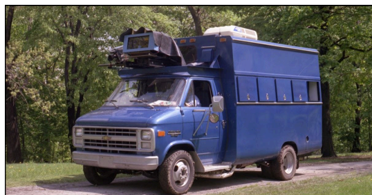
Veicolo Navlab 1, realizzato dal team di robotica della Carnegie Mellon University nel 1986.
